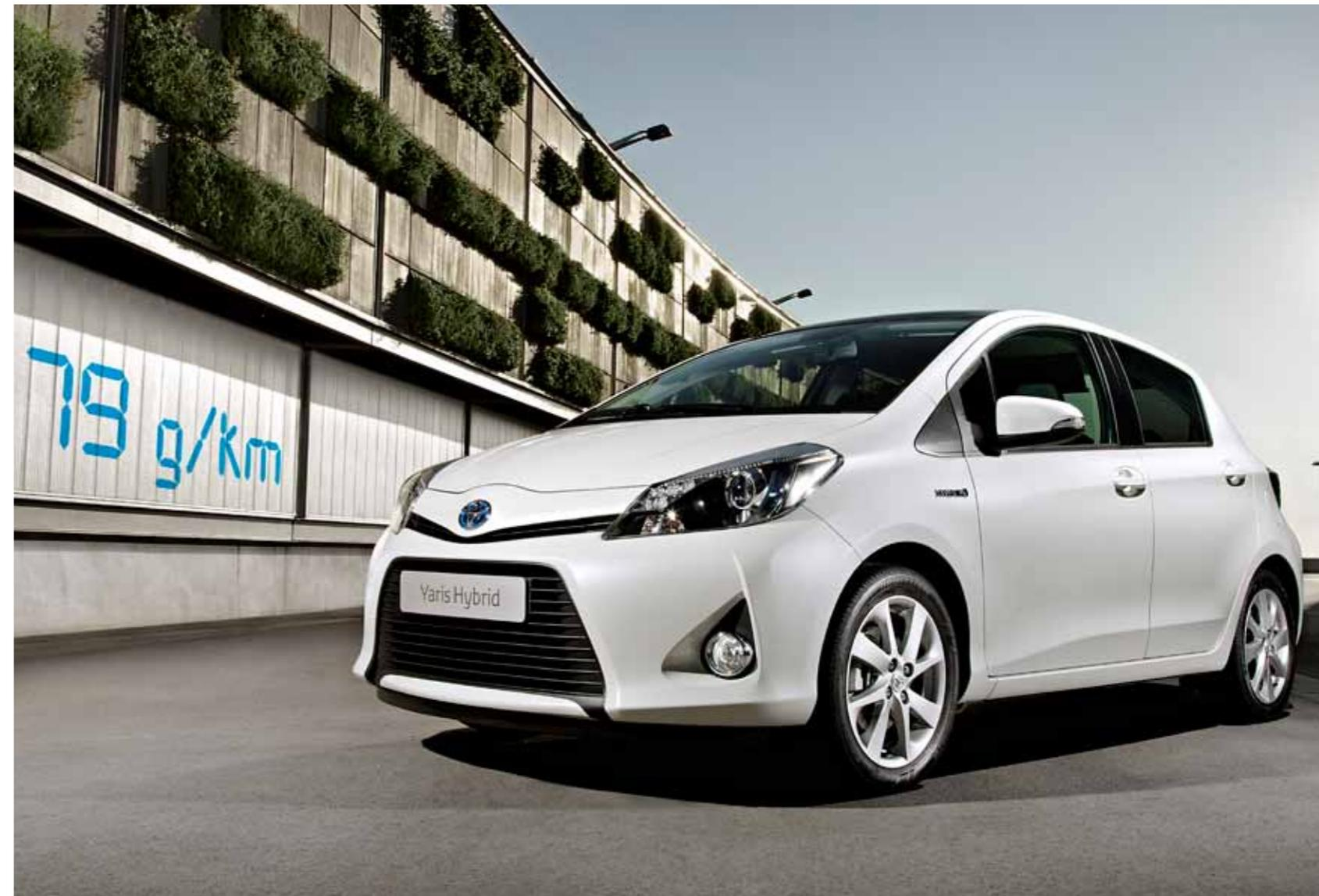
L'aerodinamica è un fattore di primaria importanza per l'efficienza dei consumi, ed è per questo che la nuova Yaris Hybrid dispone di elementi capaci di migliorare il flusso dell'aria sia sulla nuova parte anteriore che su quella inferiore mediante l'adozione di nuovi rivestimenti per il sottoscocca e di nuovi passaruota. Il risultato è che questa nuova automobile full hybrid ottiene un livello di resistenza aerodinamica ai vertici della categoria, pari a soli 0,286 Cx.
