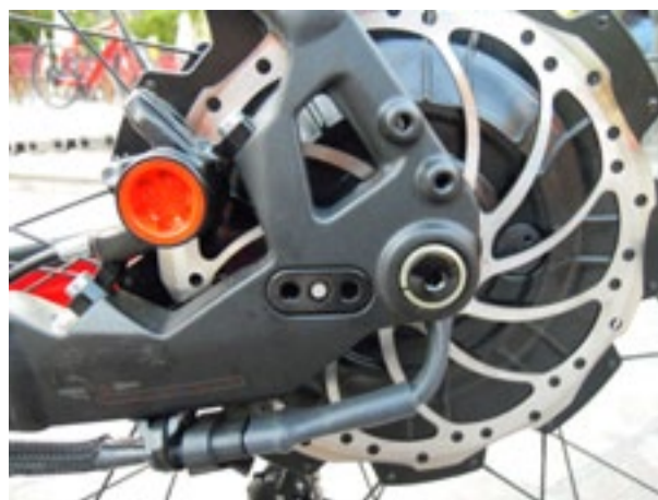
La ruota posteriore motorizzata facilmente smontabile.
