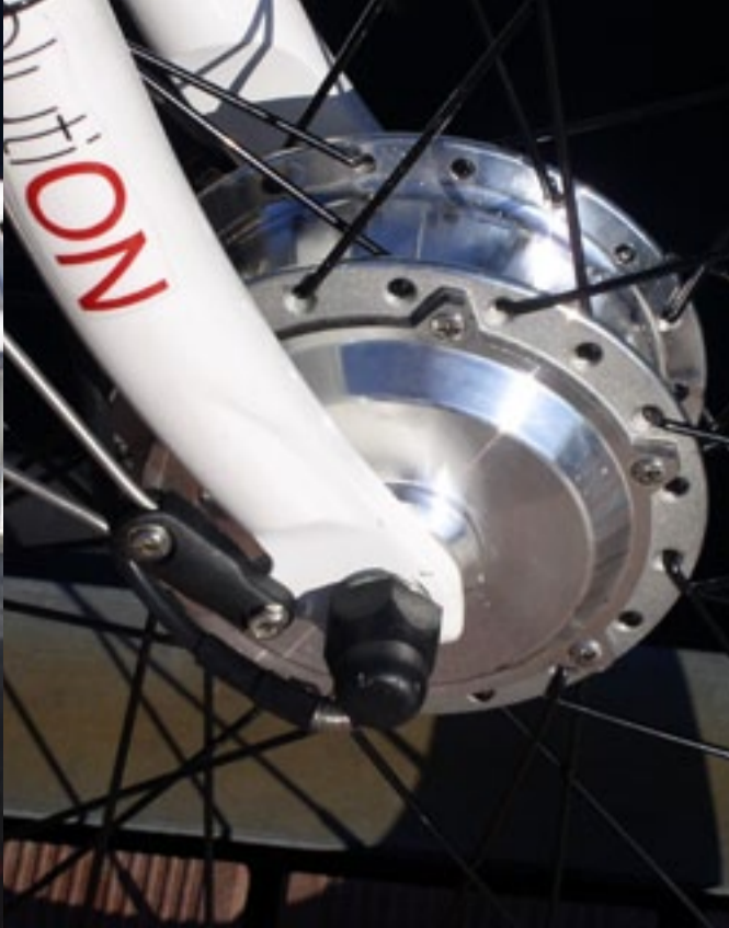
Il motore Brushless da 250W è integrato nel mozzo della ruota anteriore.
