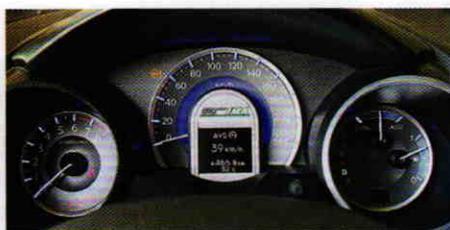
Il display al centro del tachimetro indica i consumi istantanei e medi (1), lo stato di carica delle batterie al litio (2). Se si è stati virtuosi nascono dei piccoli alberelli (3).
