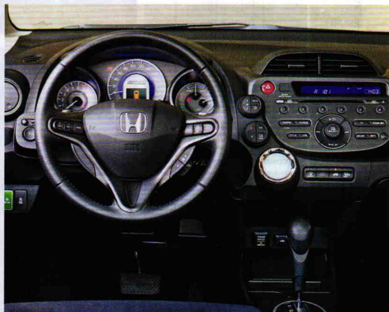
Sopra, la plancia ha un design moderno. Sotto a sinistra, la luce verde segnala che si viaggia solo con il motore elettrico. A destra, la leva del cambio automatico. In basso, il tasto ECON per limare i consumi.
