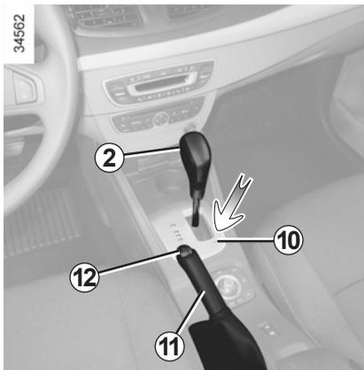
**All'avviamento**, se la leva è bloccata su **P** quando premete il pedale del freno ed il pulsante di sbloccaggio **2**, è possibile liberarla manualmente. Per effettuare questa operazione, premete il pulsante passando un oggetto nel foro **10** e contemporaneamente premete il pulsante di sbloccaggio **2** situato sulla leva.
