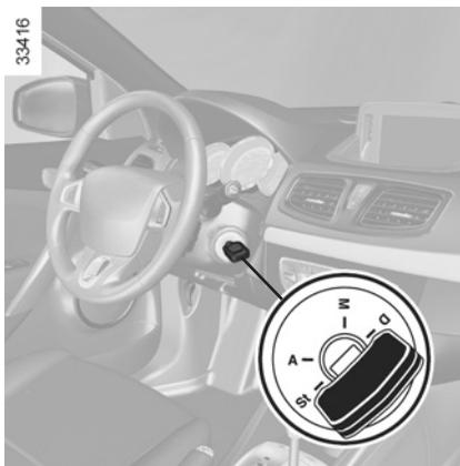
Prima di effettuare qualsiasi traino, inserite la chiave nel commutatore per sbloccare il piantone dello sterzo: Ruotate la chiave in posizione **M**.
