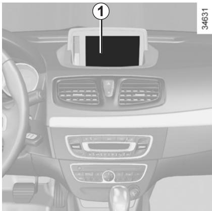
Con il **contatto inserito**, vengono visualizzate l'ora e, a seconda della versione del veicolo, la temperatura esterna.
