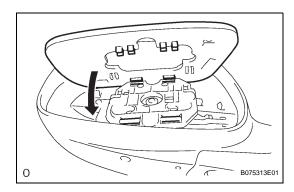
(d) Attach the 4 claws to install the mirror.
