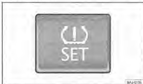
Fig. 143 Il tasto del sistema di controllo pneumatici, situato nel cassetto portaoggetti o nella console centrale
