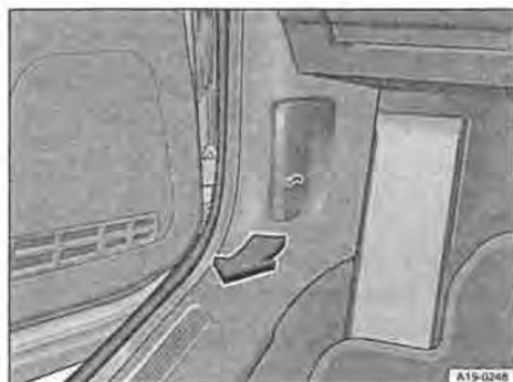
Fig. 133 Vano piedi lato conducente: leva di sbloccaggio del cofano anteriore (esempio)
