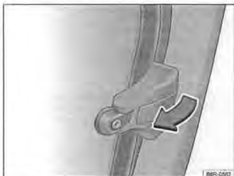
Fig. 51 Apertura del finestrino a compasso (porte posteriori)
