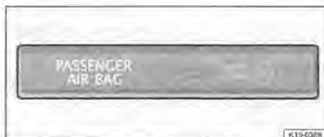
Fig. 30 Spia di segnalazione airbag frontale del passeggero attivato, collocata sulla console del tetto (esempio)
