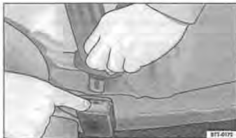
Fig. 26 Sganciamento della linguetta dal blocchetto di aggancio
