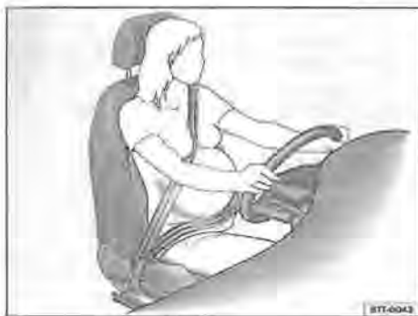
Fig. 28 Corretto posizionamento della cintura di sicurezza per donne in stato di gravidanza
