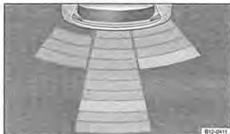
Fig. 82 Indicazione nel sistema infotainment: modalità a tutto schermo. I settori monitorati dipendono dall'equipaggiamento
