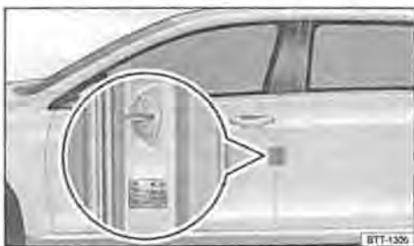
Fig. 146 La targhetta dei dati sulla pressione dei pneumatici si trova sul montante della porta del conducente o sul lato interno dello sportellino del serbatoio del carburante.
