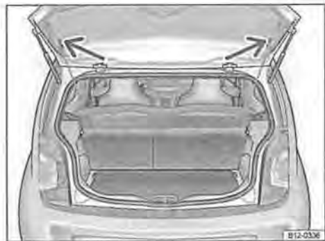
Fig. 95 Smontaggio e rimontaggio della copertura del vano bagagli
