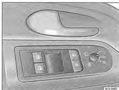
Fig. 46 Tasto della chiusura centralizzata sulla porta del conducente
