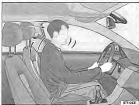
Fig. 24 Conducente che, durante una frenata brusca, viene trattenuto dalla cintura di sicurezza correttamente allacciata
