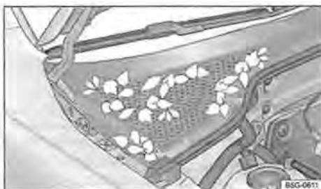
Fig. 161 Vaschetta di raccolta dell'acqua fra il vano motore e il parabrezza (esempio)
