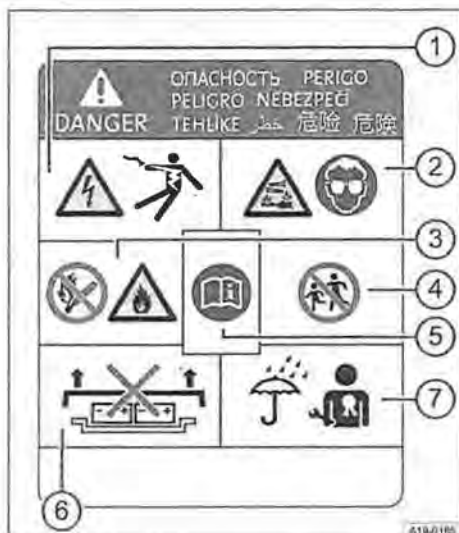
Fig. 105 Targhetta di avvertimento sulla batteria ad alto voltaggio
