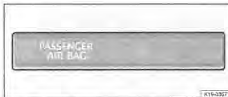
Fig. 29 Spia di segnalazione airbag frontale del passeggero disattivato, collocata sulla console del tetto (esempio)
