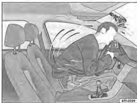
Fig. 22 Il conducente che non indossa la cintura viene proiettato in avanti
