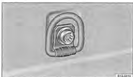
Fig. 98 Occhielli di ancoraggio estraibili nel bagagliaio
