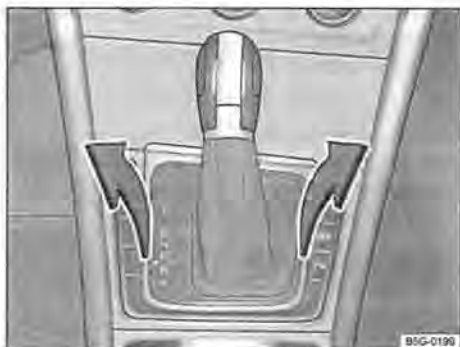
Fig. 77 Rimozione della copertura della coulisse
