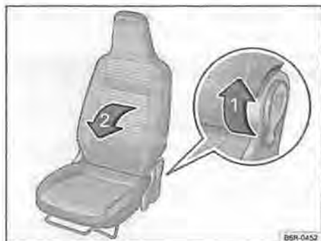
Fig. 56 Abbassamento in avanti dello schienale del sedile del passeggero
