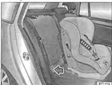
Fig. 41 Montaggio di un seggiolino con bracci di innesto (esempio)
