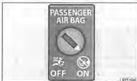
Fig. 33 Plancia, lato passeggero: interruttore a chiave per la disattivazione e la riattivazione dell'airbag frontale del passeggero
