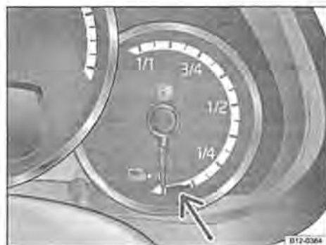
Fig. 12 Quadro strumenti: indicatore del livello di carica della batteria ad alto voltaggio con settore della riserva evidenziato in rosso
