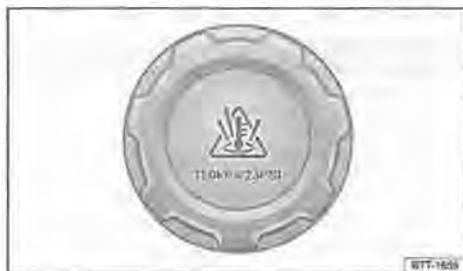
Fig. 140 Tappo del serbatoio del liquido di raffreddamento nel vano motore (esempio)
