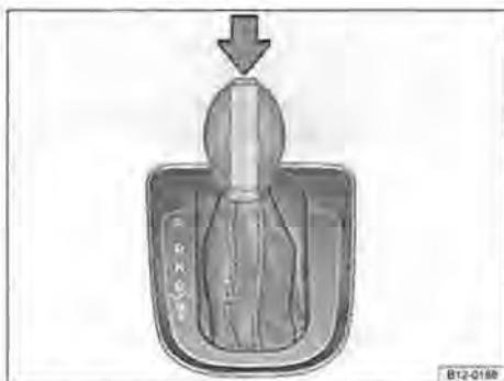
Fig. 76 Veicoli con volante a sinistra: leva selettoria del cambio automatico con tasto di bloccaggio (freccia) Nei veicoli con volante a destra la disposizione è speculare.
