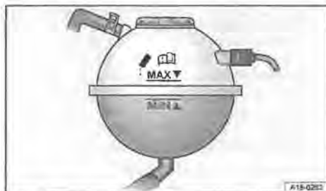
Fig. 139 Vano motore: contrassegni sul serbatoio del liquido di raffreddamento del motore (esempio)
