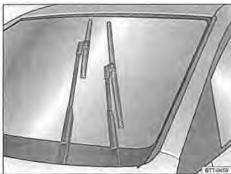
Fig. 120 Tergicristallo nella posizione di manutenzione
