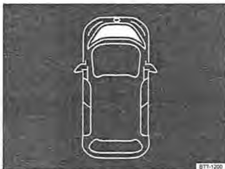
Fig. 137 Display del quadro strumenti: cofano anteriore aperto o non chiuso bene (rappresentazione schematica)
