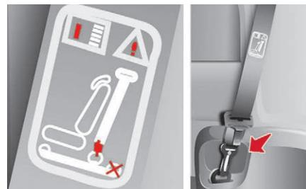
I 2 sedili sono equipaggiati ciascuno di una cintura di sicurezza a tre punti d'ancoraggio e di un avvolgitore.
