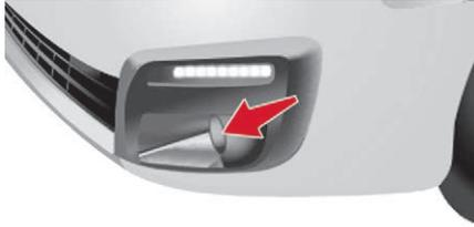
Con i fari anabbaglianti o abbaglianti accesi, questa funzione permette al fascio di luce del faro fendinebbia anteriore di illuminare l'interno della curva, quando la velocità del veicolo è inferiore a 40 km/h (guida in città, strada a curve, incroci, manovre di parcheggio ecc.).
