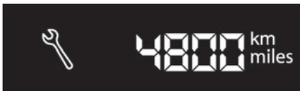
Dopo pochi secondi dall'inserimento del contatto, viene mostrato il livello dell'olio in base alla versione, poi il contachilometri torna a funzionare normalmente, indicando il chilometraggio totale e parziale.
