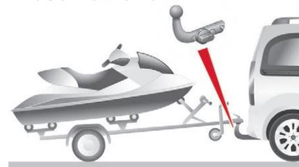
Questo gancio di traino staccabile a collo di cigno viene fornito già assemblato e può essere facilmente montato e smontato senza ricorrere ad alcun attrezzo.
