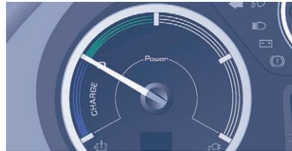
All'inserimento del contatto, il veicolo non consuma e non produce energia tramite la sua catena di trazione elettrica: dopo un'escursione, la lancetta si ripositiona su "neutro".
