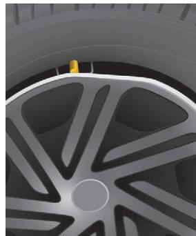
Deformazione del bordo del copricerchio in corrispondenza della valvola a causa di un montaggio non corretto.
