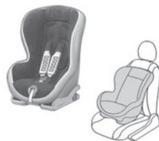
Da collocare unicamente "rivolto in avanti". Si aggancia agli anelli **A** e all'anello superiore **B**, chiamato top tether, con una cinghia alta.
