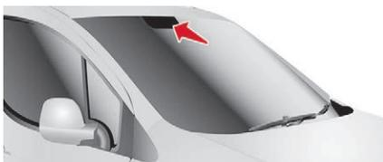
Con un sensore laser situato nella parte alta del parabrezza, questo sistema rileva un veicolo in movimento nello stesso senso di circolazione o che si trova fermo davanti al veicolo.
