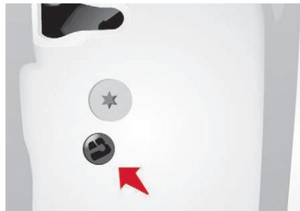
In caso di panne della batteria o della chiusura centralizzata, utilizzare la sicura per chiudere meccanicamente tutte le porte.
