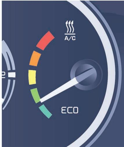
**i** Una pressione del tasto **ECO** interrompe il riscaldamento e la climatizzazione (ma conserva il funzionamento della ventilazione). La lancetta dell'indicatore di consumo e dell'indicatore di produzione di energia si posiziona nella zona **ECO**.
