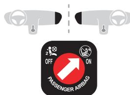
Quando si rimuove il seggiolino per bambini, portare il comando dell'airbag anteriore passeggero in posizione **ON** per attivare nuovamente l'airbag e garantire la sicurezza del passeggero anteriore in caso di urto.
