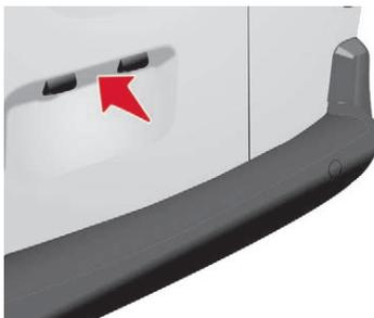
La telecamera di retromarcia si attiva automaticamente all'inserimento della retromarcia. L'immagine appare sul il tablet touch screen. La funzione telecamera di retromarcia può essere completata dall'assistenza al parcheggio.
