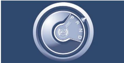
Se la leva di selezione delle marce non è su **P** e/o se il pedale del freno non è premuto, il veicolo non si avvia. Ricominciare la procedura di avviamento del veicolo.
