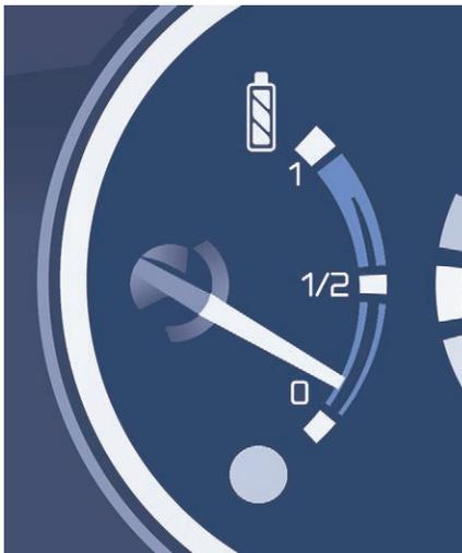
Il livello di carica della batteria di trazione rimane visualizzato in permanenza una volta avviato il veicolo.
