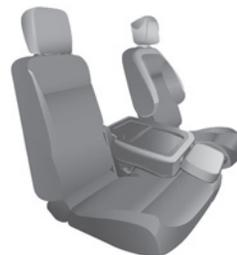
☞ Tirare la linguetta sul bordo inferiore del sedile per abbassare lo schienale integrando un tavolino, munito di una cinghia.
