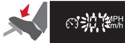
Una pressione sul pedale dell'acceleratore per superare la velocità programma non avrà effetto, tranne se si preme **forte** sul pedale e si supera il **punto di resistenza**.
