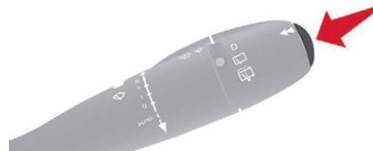
Ogni pressione del tasto, situato all'estremità del comando del tergicristallo, permette di visualizzare in successione i vari dati del computer di bordo, in funzione del tipo di display.
