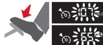
È possibile **accelerare** e viaggiare momentaneamente ad una velocità superiore a quella programmata. Il valore programmato lampeggia. Quando viene rilasciato il pedale dell'acceleratore, il veicolo torna alla velocità programmata.
