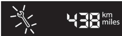
Dopo pochi secondi dall'inserimento del contatto, viene mostrato il livello dell'olio in base alla versione, poi il contachilometri torna a funzionare normalmente. La chiave di
