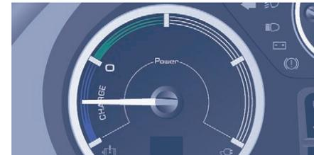
La lancetta si sposta verso sinistra proporzionalmente al livello di ricarica della batteria di trazione, durante i periodi di decelerazione e di frenata.
