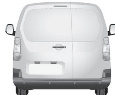
Le porte posteriori a battente sono asimmetriche (2/3-1/3), cioè hanno la porta più piccola sulla destra. Sono dotate di sistema di bloccaggio centralizzato.
