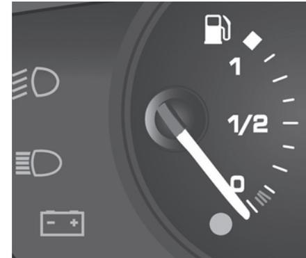
Il livello di carburante viene testato ad ogni inserimento del contatto.
