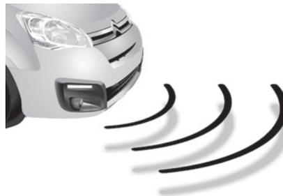
A complemento dell'assistenza al parcheggio posteriore, l'assistenza al parcheggio anteriore si attiva non appena viene rilevato un ostacolo davanti al veicolo e se la velocità dello stesso rimane inferiore a 10 km/h.
