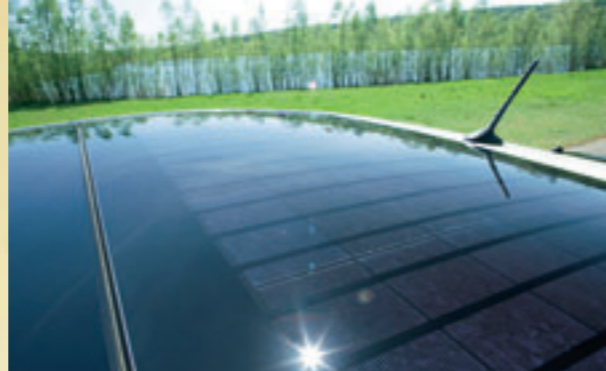
La porzione posteriore del tetto piastrellata di celle fotovoltaiche: alimentano la ventilazione forzata dell'abitacolo
