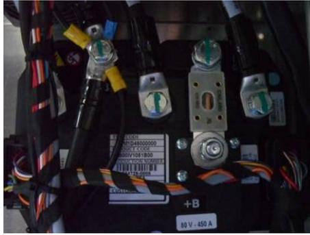
Fig. 10.8 – Fusibile di potenza alimentazione controller
