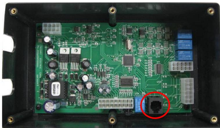
Fig. 3.10 – Centralina BMS (in evidenza il connettore di programmazione).
