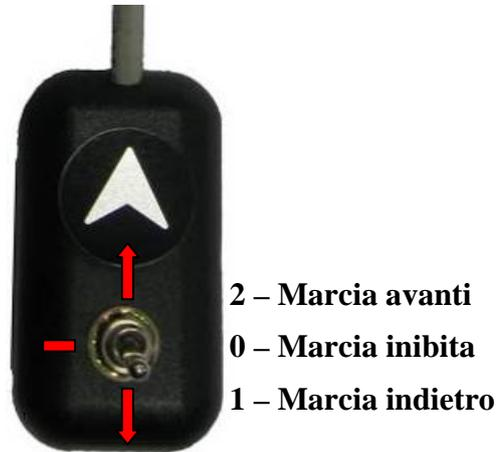
*Fig. 9.4 – Pannello movimentazione – spiegazione posizioni.*
