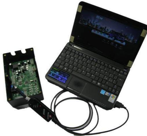
Fig. 6.3 – Programmatore PICkit 2 collegata al Pc assistenza e alla periferica da programmare (Centralina BMS nella foto).
