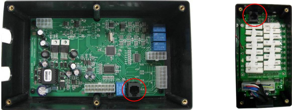
Fig. 6.1 – Connettore di programmazione Centralina BMS e Moduli BMS.
