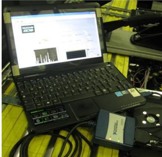
Fig. 5.1 – PC assistenza connesso all'Adattatore CAN to USB.
