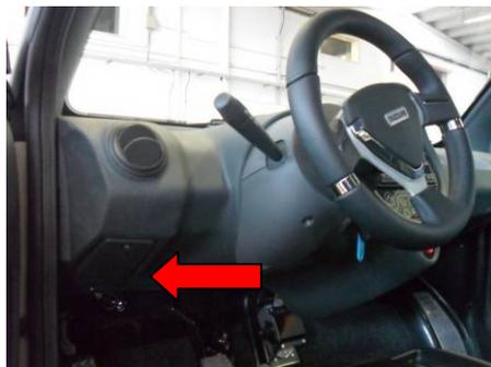
Fig. 10.1 – Vano fusibili principali.
