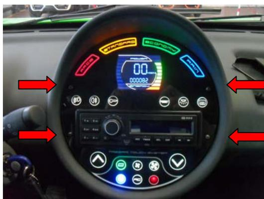
Fig. 10.4 – Plancia Touch, smontaggio.
