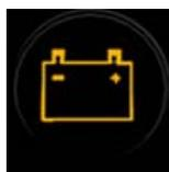
Fig. 3.11 – Spia riserva energia o codifica anomalie nel sistema BMS.
