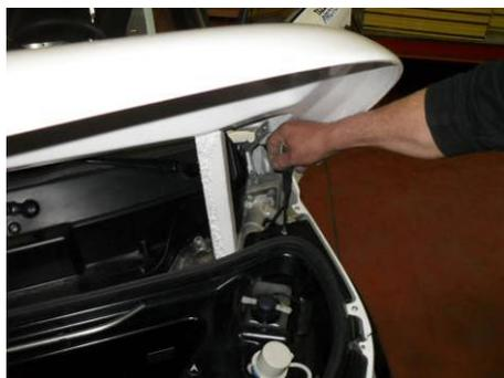
Svitare, con l'aiuto di un cacciavite a croce, le 6 viti che fissano il bagagliaio anteriore del veicolo al telaio del veicolo stesso.
