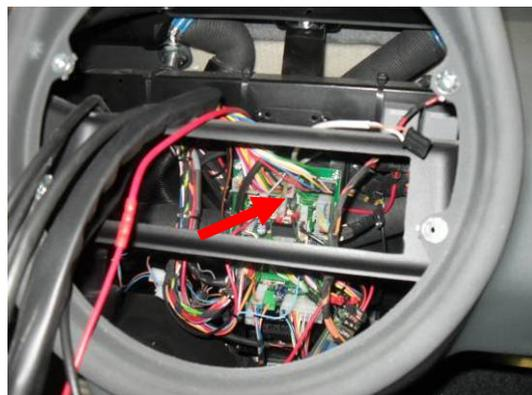
Fig. 9.3 – Scheda interfaccia montata sul veicolo.
