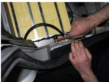
Avvitare il controdado in modo da bloccare il tampone batteria.
