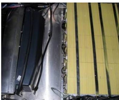
Fissare dal lato passeggero, con l'ausilio di una chiave a brugola da 4mm e di un cacciavite a croce, le 4 viti che fissano il supporto in alluminio del convertitore al veicolo ed il convertitore dal supporto stesso.
