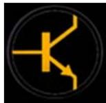
Fig. 7.3 – Spia codifica errori gestione elettronica della trazione.
