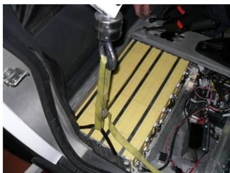
Assicurarsi che i pacchi batterie posteriori siano correttamente alloggiati e cioè con la parte inferiore a contatto con il fermo in alluminio come mostrato in foto.
