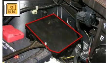
2. Dargestellte Sicherungen im Kastendeckel entfernen.
