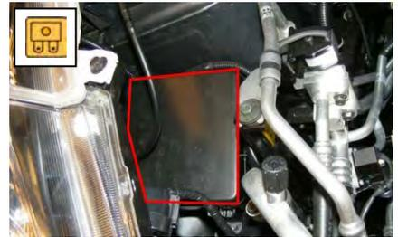
4. Dargestellte Sicherung im Kastendeckel entfernen.
