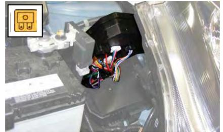
2. Dargestellte Sicherungen im Kastendeckel entfernen.
