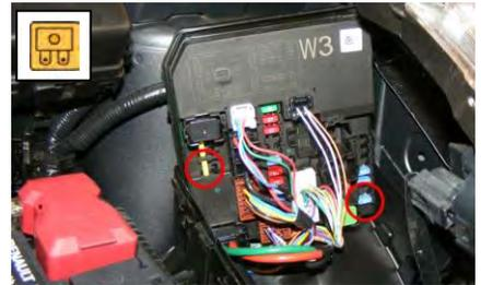
3. Sicherungskasten 2 lokalisieren und öffnen.
