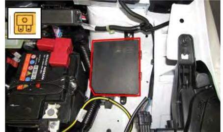
2. Dargestellte Sicherung im Kastendeckel entfernen.
